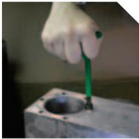
4. Aparafusar a inserção na peça de fundição
