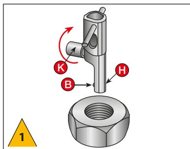
1 Gire o manípulo (K) para recolher por completo a lâmina (B) na carcaça (H). Insira a ferramenta **Nes Internal** no furo roscado para ser reparado.
