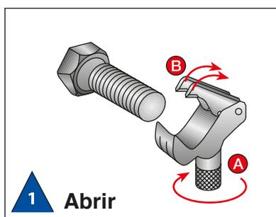
1 **Abrir** Rodar o manípulo (A) para levantar as lâminas (B). Insira a ferramenta **Nes External** na rosca para ser reparada.
