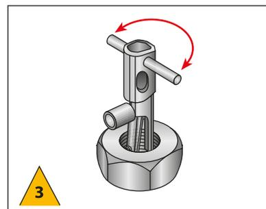
3 Rode a ferramenta **Nes Internal** através da barra transversal (conforme mostrado acima), na direção desejada.
