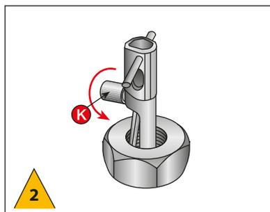
2 Gire o manípulo (K) no sentido contrário para expandir a lâmina num sulco da rosca não danificado e apertar levemente.
