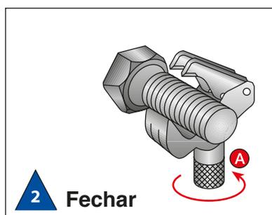
2 **Fechar** Rodar o manípulo (A) no sentido contrário para as lâminas coincidirem nos sulcos da área danificada e apertar levemente.
